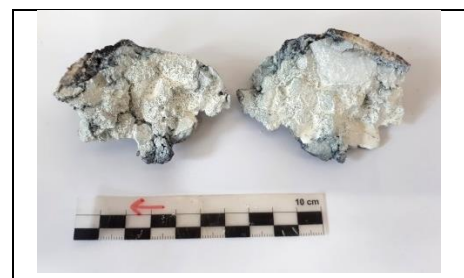
Bild 2: Asphalt mit Lack nach ca. 30 Sek.
